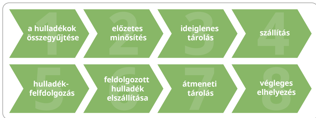
5.15 ábra A radioaktív hulladékok kezelésének folyamata. (Saját szerkesztés https://atomeromu.mvm.hu/-/media/PAZrtSite/Documents/Tudastar/HogyanMukodik/Radioaktiv-hulladekok.pdf?la=hu-HU alapján, 2021)
